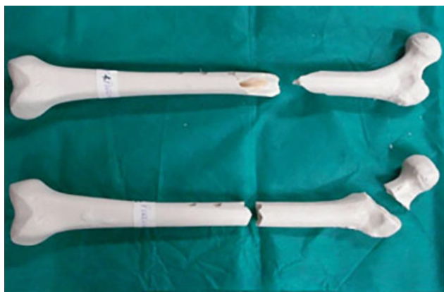
Fig. 4 Espécimes sintéticos com fratura do colo e da diáfise (superior) e da diáfise (inferior) após teste mecânico.
