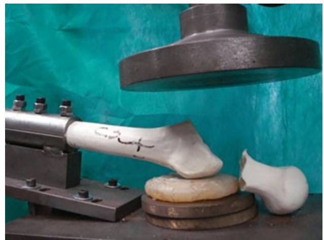
Fig. 3 Osso sintético após a realização do teste mecânico. Observa-se fratura basocervical de espécime.
