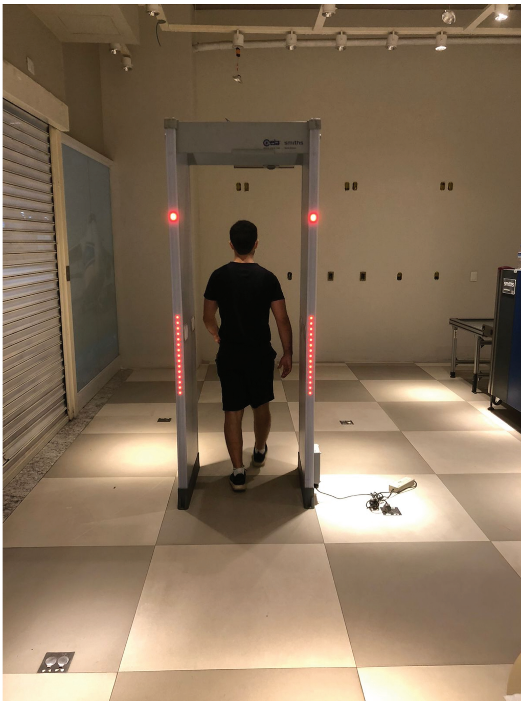
Fig. 2 Teste de controle para certificar o funcionamento adequado do detector de arco usando celular no bolso.
