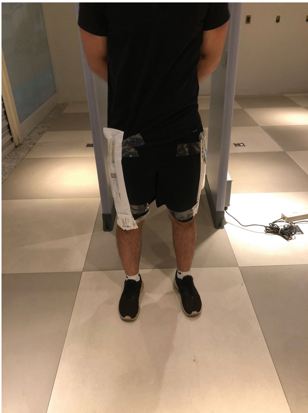
Fig. 4 Haste femoral retrógrada bilateral fixada na superfície lateral das coxas antes do teste.
