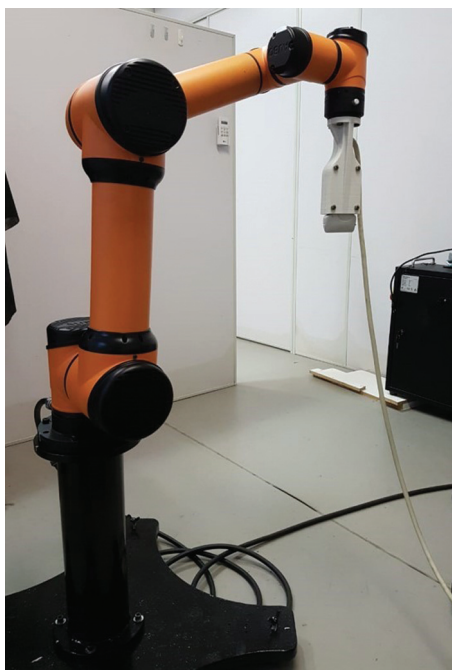
Fig. 6. Braço robótico mantendo posicionamento do transdutor linear.
