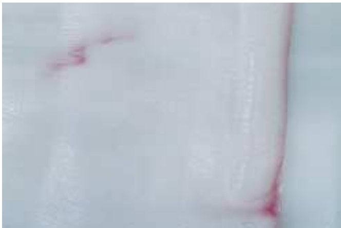
Abb. 3 Roter Streifen von zerquetschten Kobaltchloridkristallen in der Vaseline beim Aufarbeiten einer gealterten Testspritze auf dem Dreiwalzenwerk.
