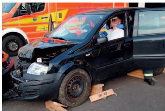
► **Abb. 3** PKW-Sicherung/-Unterbauung
