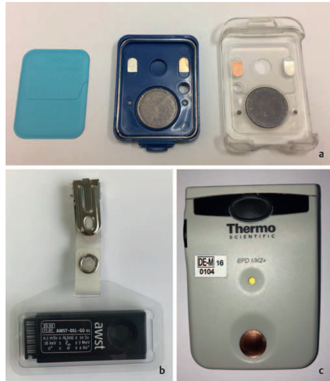
► Abb. 6 a Filmdosimeter mit unterschiedlichen Abschirmungen zur Dosisbestimmung (v.l.n.r.: Röntgenfilm, Kassettenboden mit Kupfer und Bleiabschirmungen, Kassettendeckel mit Kupfer und Bleiabschirmungen). b BeOSL-Dosimeter. c Elektronisches Personendosimeter (EPD).
