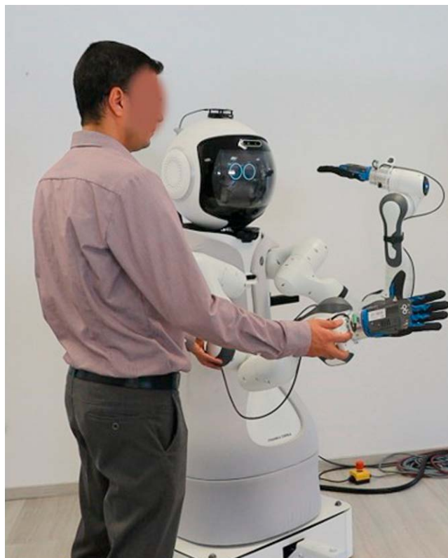
► Abb. 1 GAMI, ein intelligenter Serviceroboter für die Anwendung im Alltag oder im Gesundheitsbereich.
