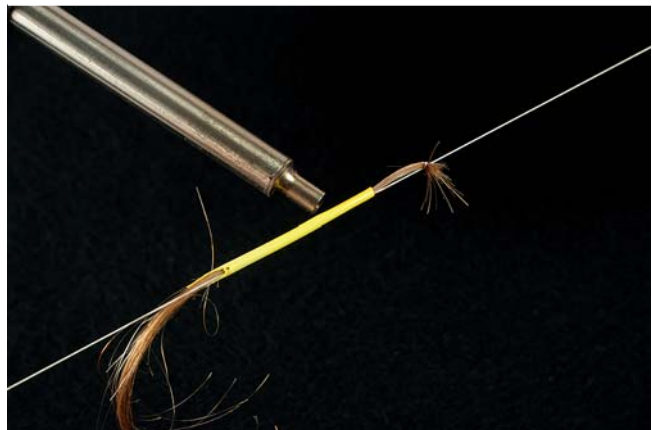
Abb. 4 Erwärmen des Schrumpfschlau- ches mit einer Heißluftpistole.
