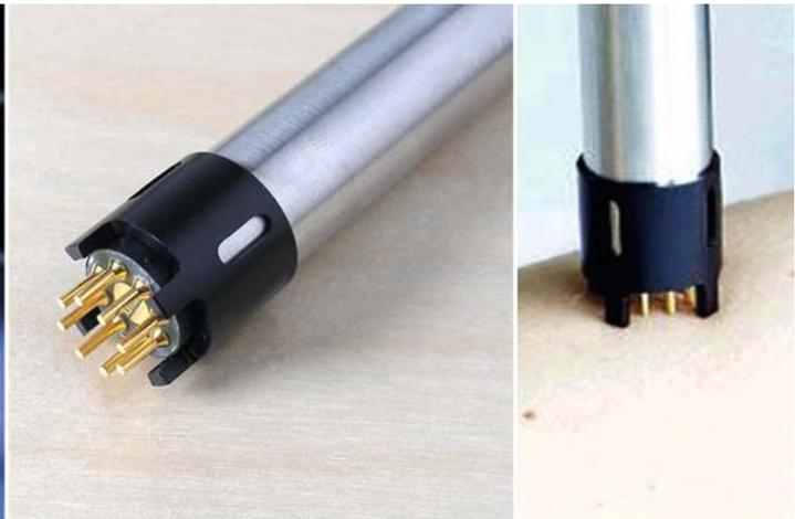
**Abb. 2** Quantifizierung der Hautfeuchtigkeit mit der Pin-Sonde (DermaLab®, Cortex Technology) – das spezielle Design mit acht Pins ermöglicht die Messung der Hautleitfähigkeit selbst bei trockener und behaarter Haut.
