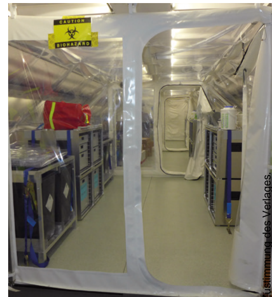
Abb. 2 Airbus A340-300 „Robert Koch“: Blick in die Isoliereinheit mit Vorraum, Schleuse und Behandlungsraum.
