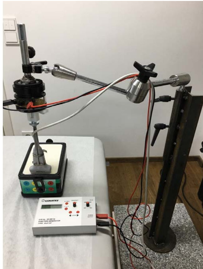
► Abb. 1 Gelenkarm mit Vibrationsgenerator
