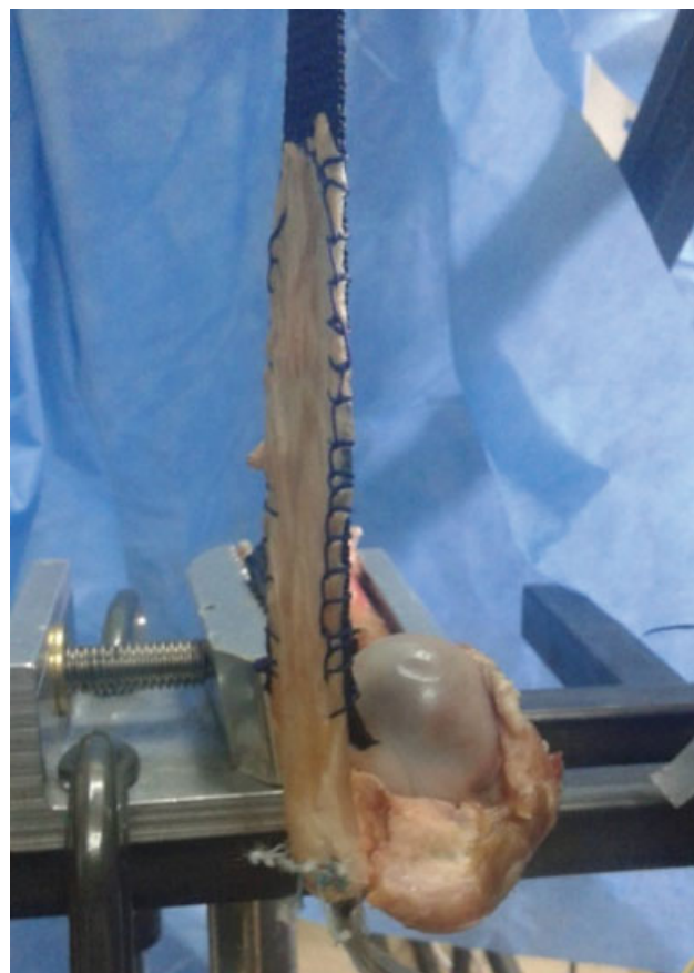
Fig. 3 Soporte modular. El soporte modular fue ajustado para asegurar el paralelismo del tendón con la vertical.
