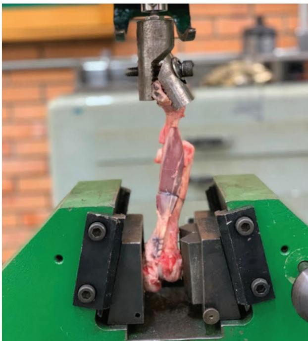
**Fig. 5** Sistema montado com âncora metálica.
