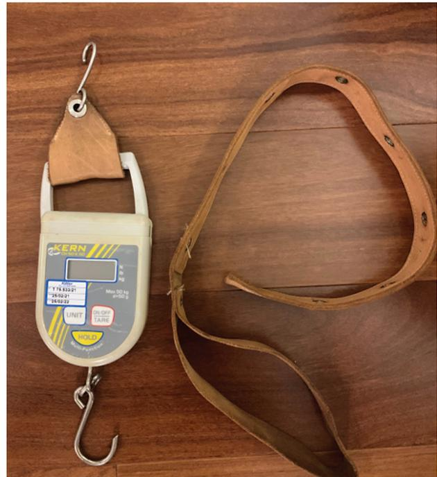
**Fig. 1** Foto de frente do dinamômetro digital KERN CH50 K 50, devidamente calibrado, utilizado para mensuração de força isométrica do ombro.
