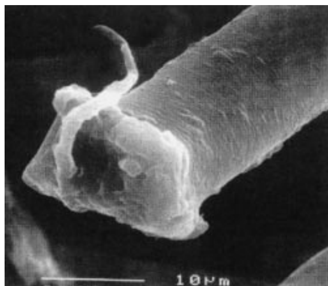
Abb. 2 Elektronenmikroskopische Aufnahme des geschnittenen Endes einer Nylon-Faser mit „Schwänzchen“ (Querschnitt der Flock-Faser ca. 15 \mu\text{m} , Querschnitt des Schwänzchen ca. 1 \mu\text{m} ) [3, 4].
