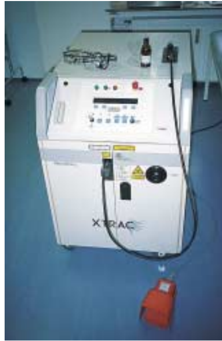
Abb. 1 Excimer-Laser 182 kg, Höhe 92 cm, Tiefe 95,25 cm, Breite 63,5 cm; Laserschutzbrillen für Arzt und Patient, Bestrahlungs-Randbegrenzungsschablone, Mineralöl, und fiberoptisches Handstück auf dem Gerät, Fußschalter vor dem Gerät.
