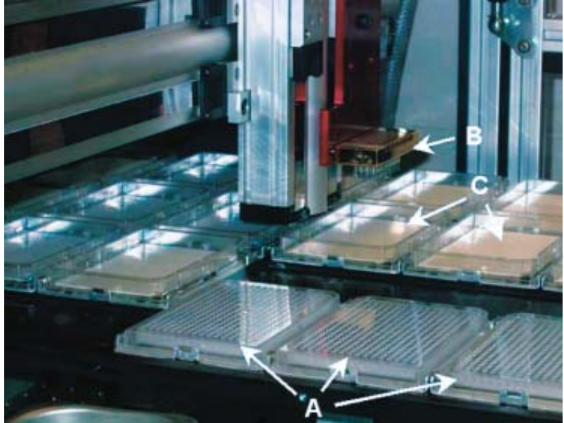
Abb. 1 Herstellung von Nylonmembran-Arrays im „Spotting“-Verfahren
