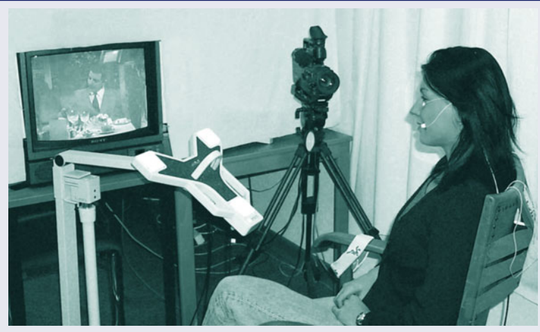
Probandin mit Ultraschallmarkern im Gesicht, Fernsehschirm zur Darbietung des emotionsinduzierenden Filmmaterials („Mr. Bean“), Videokamera und Ultraschallmessaufnehmer
