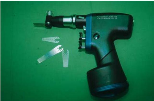
Abb. 5 4 von 15 verschiedenen Sägeblättern mit oszillierender Säge
