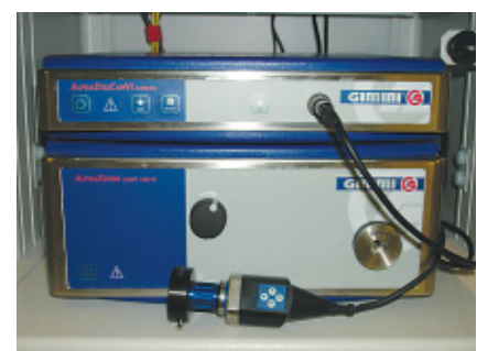
Abb. 3 Xenon-Lichtquelle und Steuereinheit mit Kamerakabel und Kamera.
